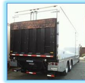
Rampa tipo compuerta
