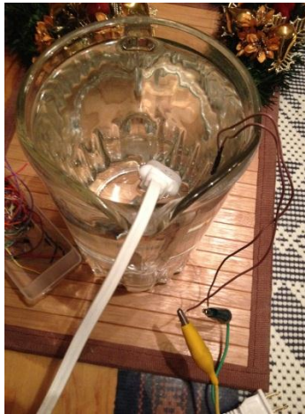
Figura 7. Jarra de agua con resistencia eléctrica y el termistor sumergido para medir las variaciones de temperatura
