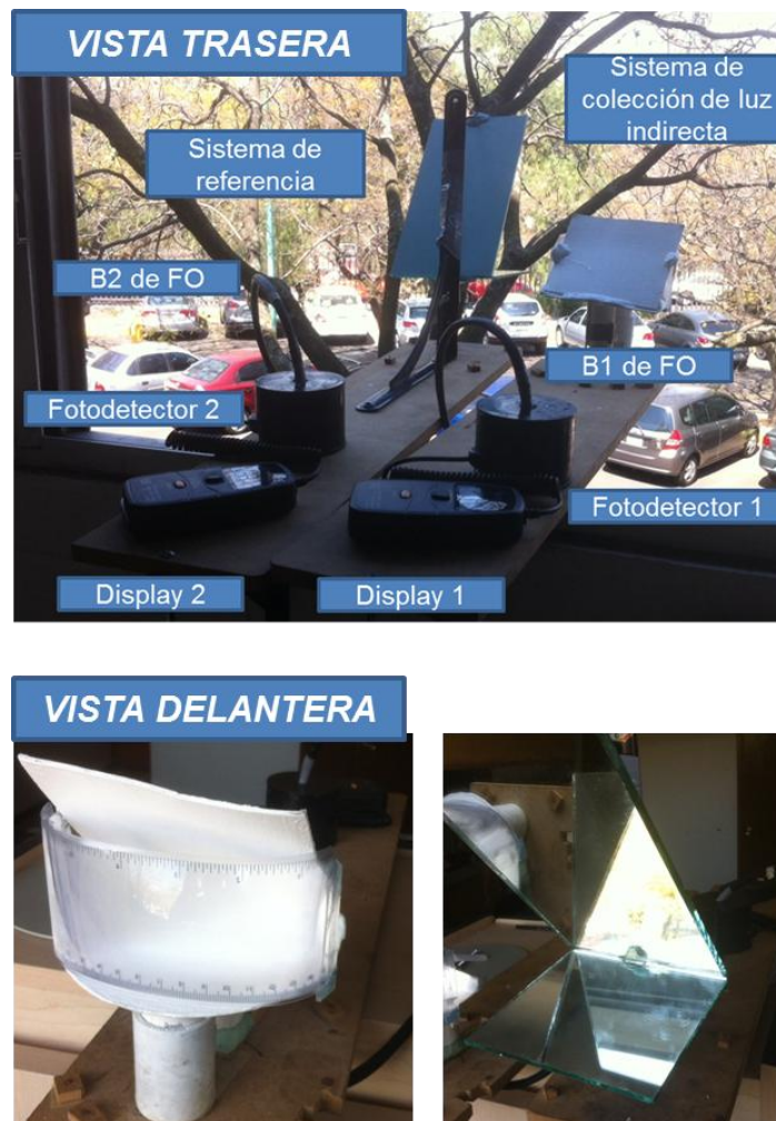
Figura 5.1.b. Montaje real de los elementos empleados en las pruebas de medición en condiciones de luz natural.
