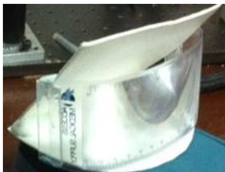
Figura 4.6. Prototipo del sistema de colección de luz indirecta con lente de fresnel curva.
