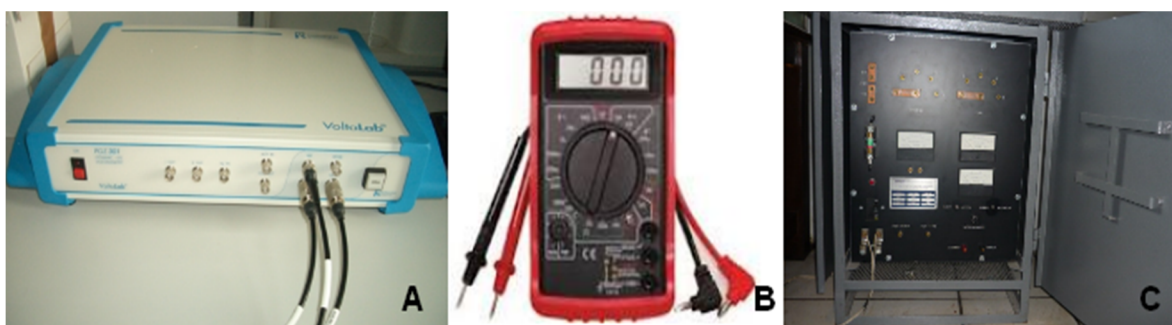
Figura 2.6. A) Potenciostato / Galvanostato, B) Multimetro y C) Rectificador.
