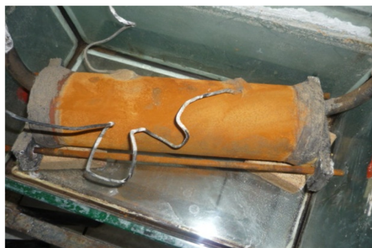
Figura 3.5. Fotografía del tubo desnudo a 25°C al finalizar el monitoreo.
