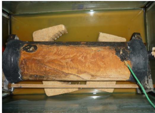
Figura 3.6, Fotografía del tubo desnudo a 50°C al finalizar el monitoreo.
