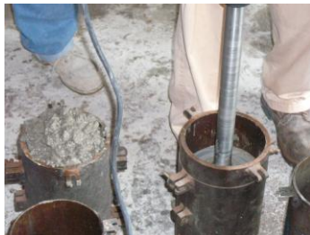
Fig. 4.21 Compactación de capas de CCR en moldes cilíndricos
