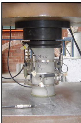
FIG. 5.32 Ensaye a módulo de elasticidad y relación de Poisson.
