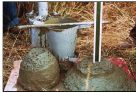
Fig. 3.2 Prueba de revenimiento.
