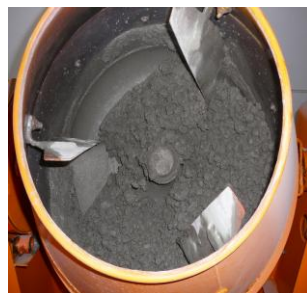
Fig. 4.18 Mezclado de CCR en revolvedora de 90 lt.
