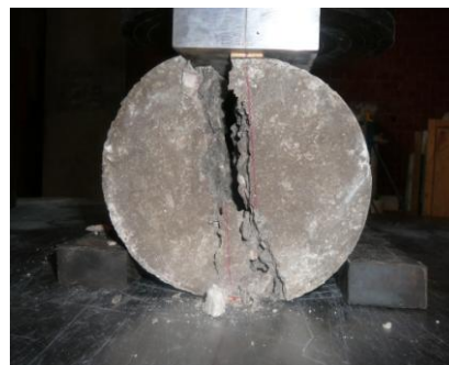
Fig. 5.21 Falla de cilindro ensayada a tensión indirecta.
