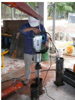
Fig. 4.17 Compactación de capas de CCR en moldes cilíndricos.
