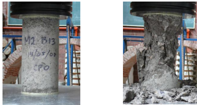
Fig. 5.8 Especímenes de CCR de 15 X 30 cm ensayados a compresión simple
