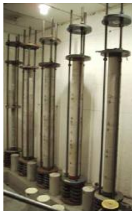
Fig. 3.13 Marcos para flujo plástico en la cámara seca
