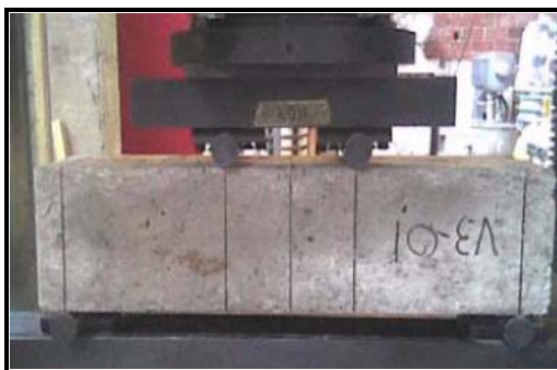
Fig. 5.26 Ensayo ASTM C-78. Viga de CCR de 15 cm X 15 cm X 60 cm.
