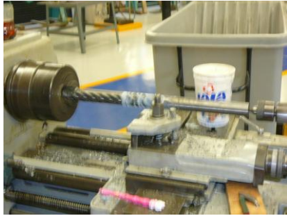
Fig. 4.15 Torneado de varilla corrugada para la fabricación del vástago.
