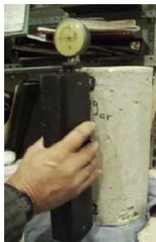
Fig. 3.14 Mediciones empleando el deformimetro (equipo whitmore)
