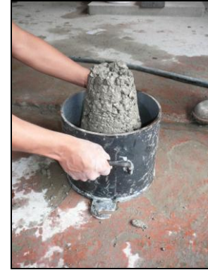
Fig. 5.1 Revenimiento cero del CCR.
