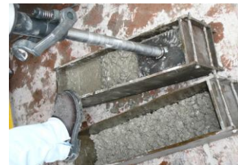
Fig. 4.22 Compactación de capas de CCR para la fabricación de vigas
