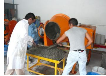
Fig. 4.20 Vaciado de CCR en la artesa de metal.
