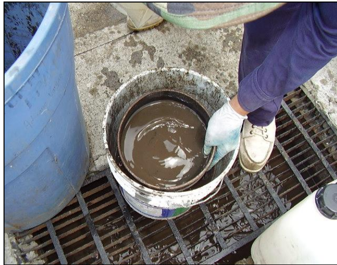
Fig. 4.4 Proceso de obtención de lodos activados (cribado de la muestra)
