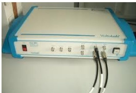
Foto 2.2 Voltalab PGP 201 Potentiostat / Galvanostat
