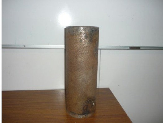
Foto 2.1 Ducto de acero API X-52
