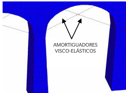
Figura 1.4. Ubicación de amortiguadores visco-elásticos
