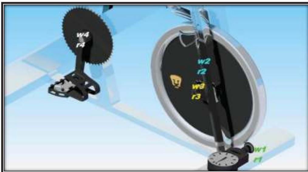
*Figura 5.1. Ubicación del tacómetro durante las mediciones*
