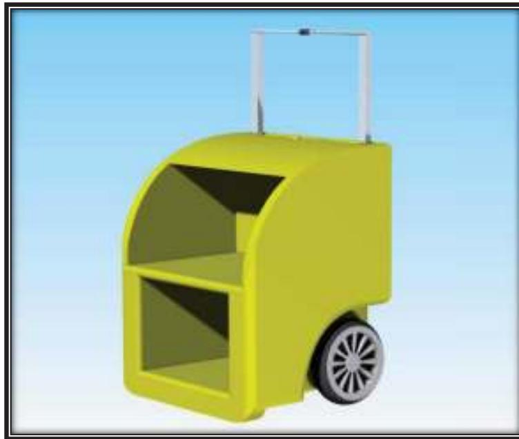
*Figura 5.20. Carro transportador.*
