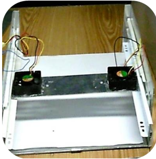
Figura 2.15 Ventiladores para mover las hojas.
