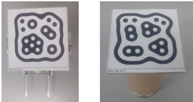
Figura 6. 2: Fiducials para los cobots y las cajas.
