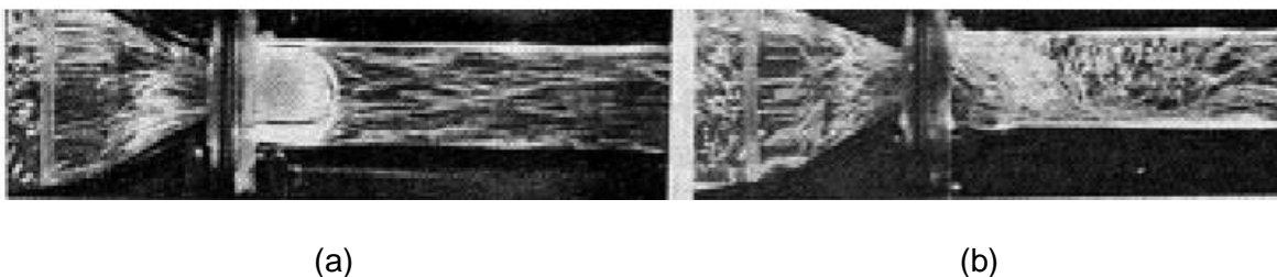
Figura 4.5 Característica de flujo en un modelo Jaula-bola y un modelo disco oscilante [8].
