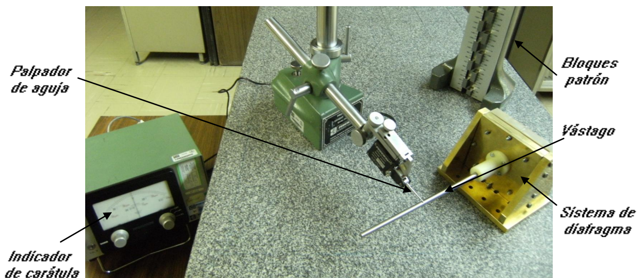
Figura 5.26. Medición de la altura del vástago utilizando un maestro de alturas.
