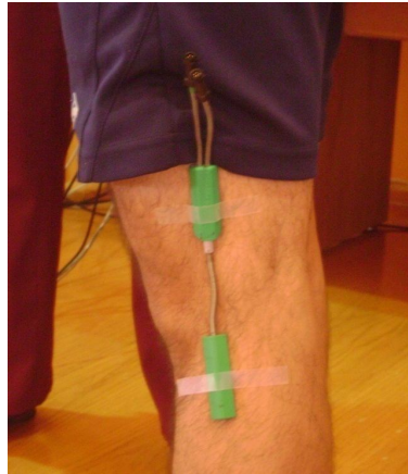
Figura 30. Instalación del goniómetro.
