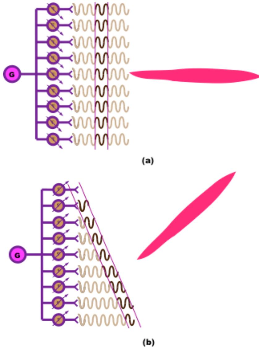
**Figura 1.2** Principio de operación de antenas en arreglos de fase.
