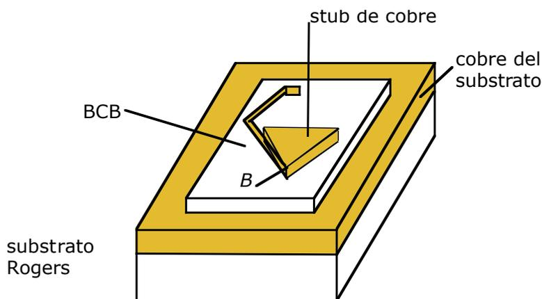
**Figura 3.3** Estructura del circuito de polarización
