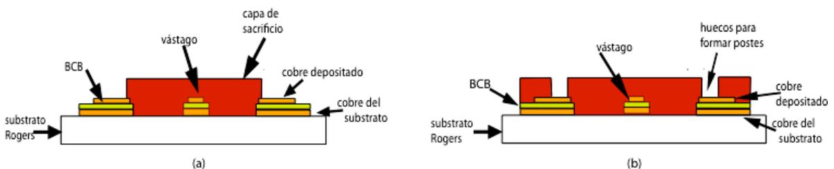
**Figura 4.18** Vista lateral de los dos tipos de formación de la capa de sacrificio para la estructura del puente MEMS-RF. (a) escalón estructural para moldeo del puente (b) formación de huecos para el conformado de los postes del puente.
