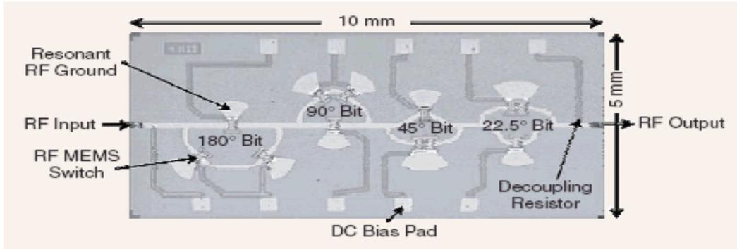
**Figura 1.4** Esquematización de un desplazador MEMS de 4 bits [4].
