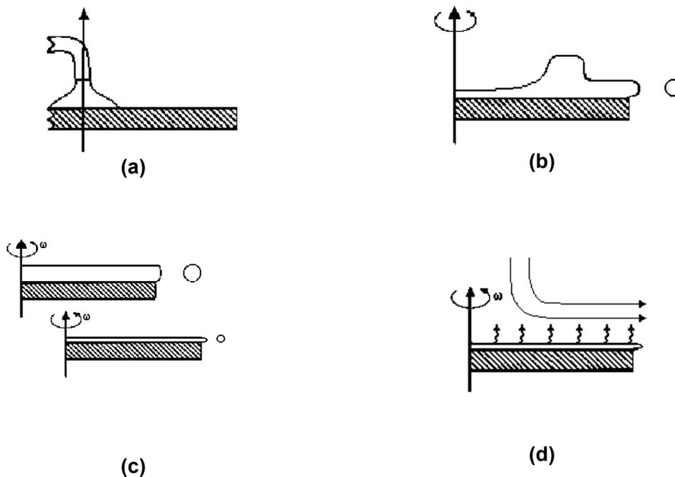
**Figura 4.7** Etapas del proceso de spin coating: (a) depósito del fluido; (b) spin up, expulsión del exceso de fluido; (c) spin off, adelgazamiento y homogeneización de la capa (d) evaporación del disolvente.
