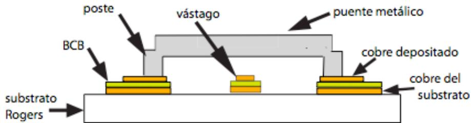
**Figura 4.5** Esquema de la vista lateral de la estructura MEMS con diseño tipo puente (air-bridge) propuesta como conmutador de RF.
