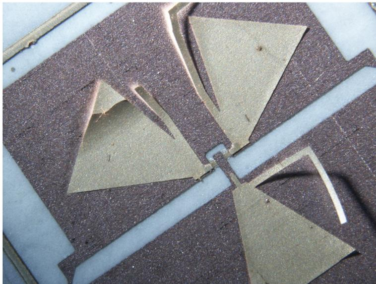
**Figura 4.17** Micrografía que muestra el desprendimiento del CYCLOTENE en la etapa final después de la fotolitografía en la capa de aluminio para la formación del puente.
