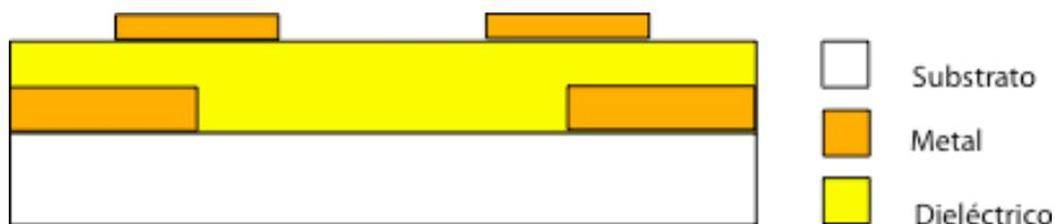
Figura 2.5 Estructura metal/dieléctrico/sustrato (Cu/BCB/Ro)
