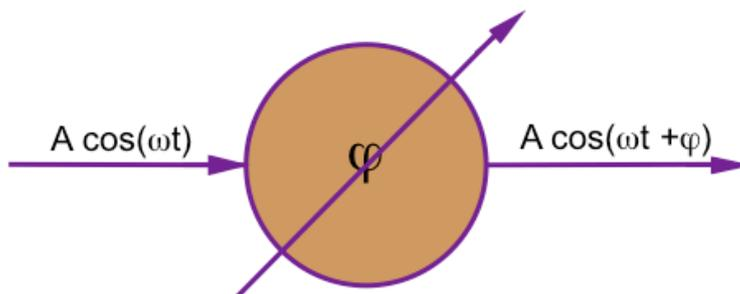
**Figura 1.1** Elemento desplazador de fase aislado.
