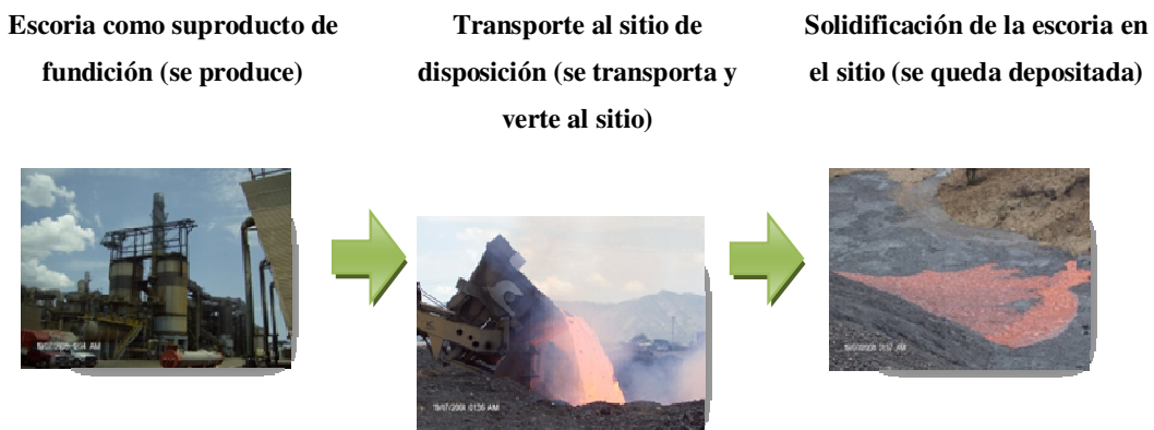
Fig.II.1 Escoria como subproducto de la fundición de metales y su disposición final
