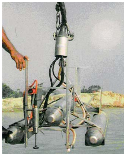
Figura 3. 15 Dispositivo de transporte del muestreador bomba, para funcionar debajo del agua
