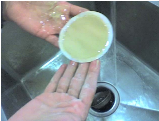
Figura 6.1.1-4: Enjarre después de aplicar fuerza hidráulica
