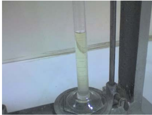
Figura 6.1.1-1: Líquido arrojado por el fluido de perforación
