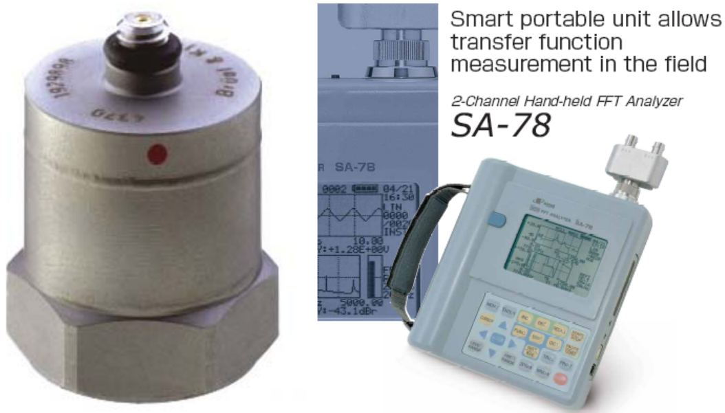
Fig 3.6. Acelerómetro (Briel & Kjær 4370) y analizador de espectros portátil de dos canales (RION SA-78WR).
