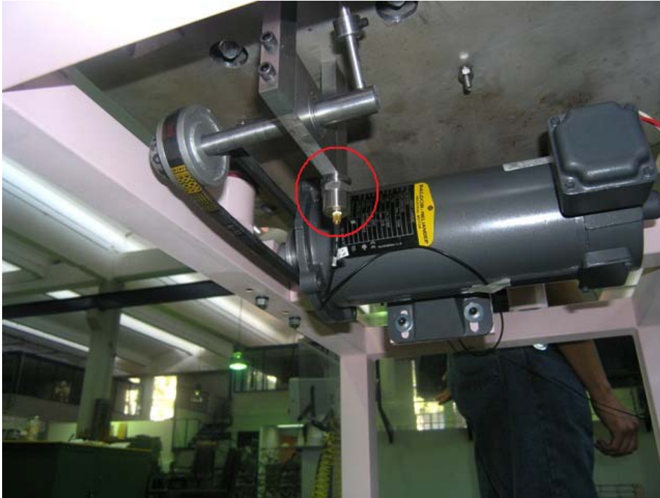
Fig. 6.7. Medición por debajo de la base del sistema antivibratorio.
