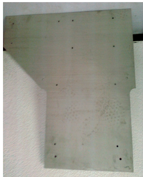
Fig. 5.2. Fotografía del proceso de corte del soporte del sistema mediante corte por chorro de agua. Dibujo y fotografía de la parte física del soporte del sistema.
