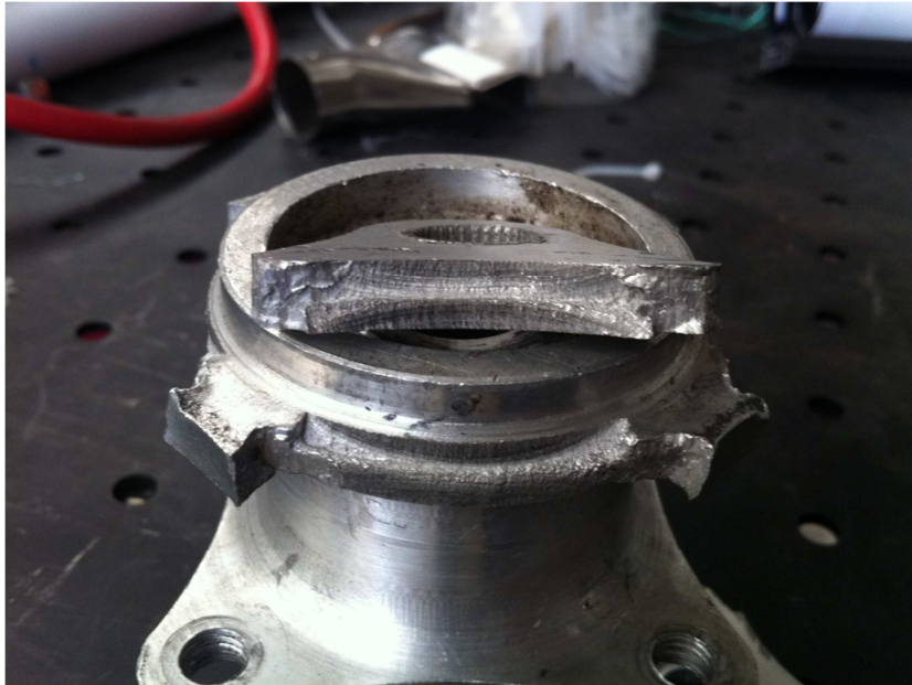
Fig. 7. 3 Fotografía de la maza delantera fracturada.
