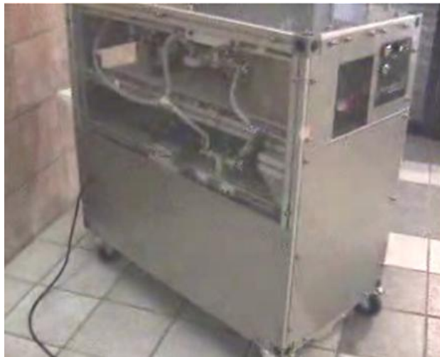
Fig. A-10.1 Máquina desespinaadora láser para nopal. Tomado de http://www.elsiglodetorreon.com.mx/noticia/268403.desarrolla-ipn-desespinaadora-laser-para-nopal.html , fecha de consulta: 15 de Octubre de 2009.
