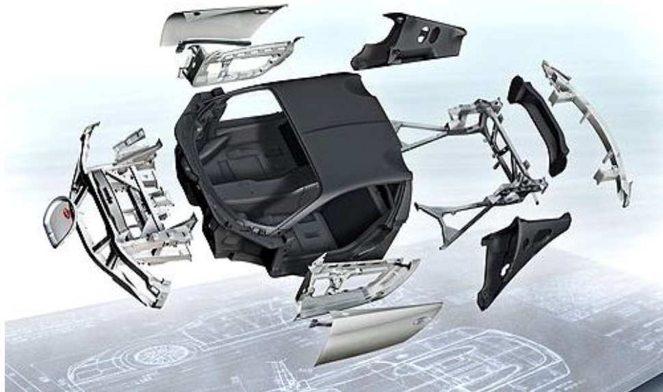
Figura 1.5 Bugatti Veyron 16.4 compuesto por dos chasis (delantero y trasero) además de un centro monocasco.
