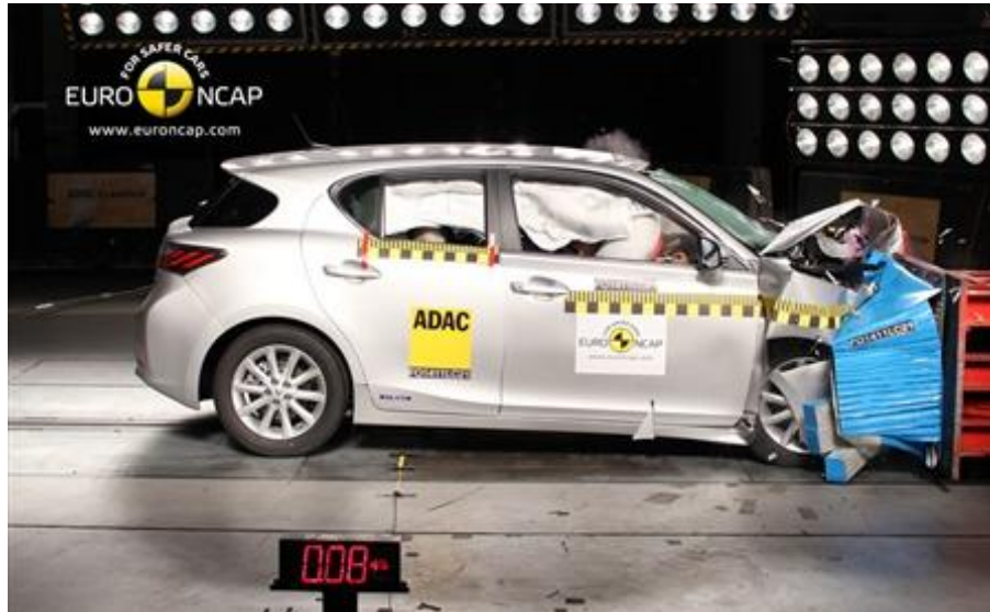
Figura 2.3 Lexus CT200h prueba de impacto frontal. [EURO NCAP, 2011]
