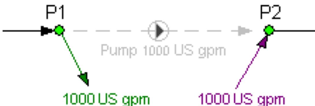
Figure 2.8. Reemplazo de la Bomba de Caudal Fijo.
