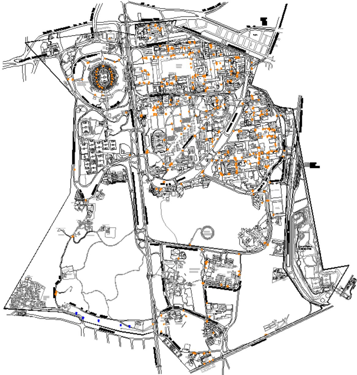
**Figura 3.10. Localización de válvulas. En color naranja se encuentran las válvulas de compuerta, y en color azul la de expulsión de aire.**
