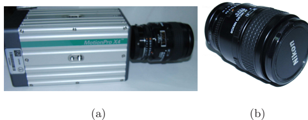
Figura 2.7.: Cámara de alta velocidad y lente AF Micro Nikon de 60mm. (a) Cámara de alta velocidad MotionPro X4 usada en las pruebas del laboratorio. (b) Lente usada con la cámara de alta velocidad (AF Micro Nikon de 60mm).
