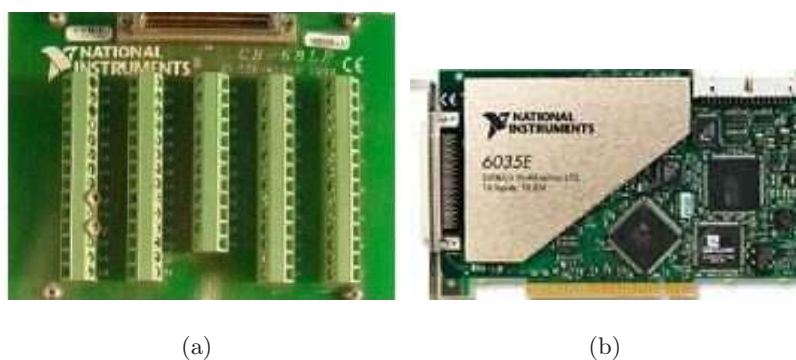
Figura 2.11.: Tarjeta de adquisición de datos de National Instruments modelo PCI-6035E. (a)Pines de conexión. (b)Circuito.
