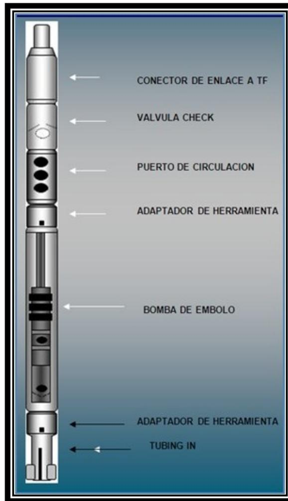
Figura3. 19 Diagrama del Ensamblaje de Fondo.
