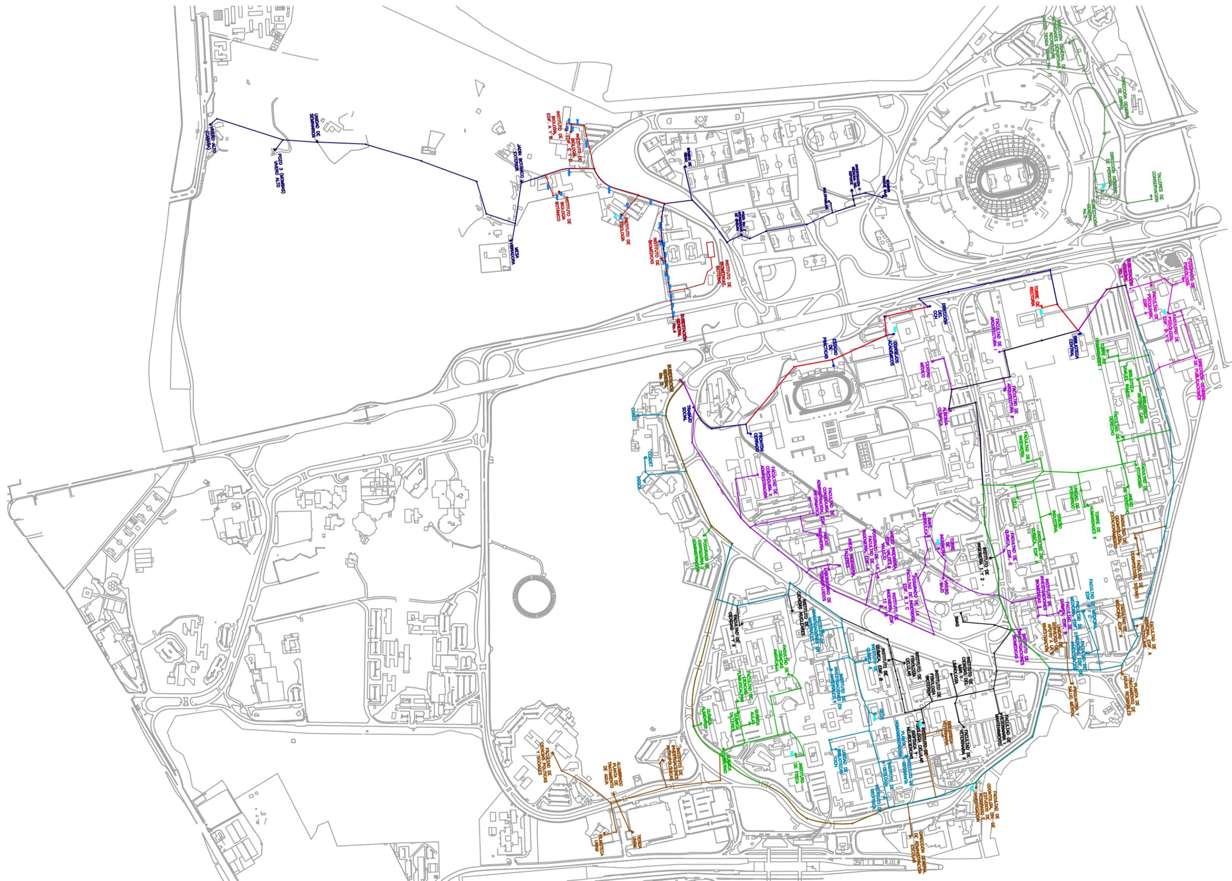
Figura No. 3.20. Plano General de la Nueva Red de Distribución Subterránea en CU.
