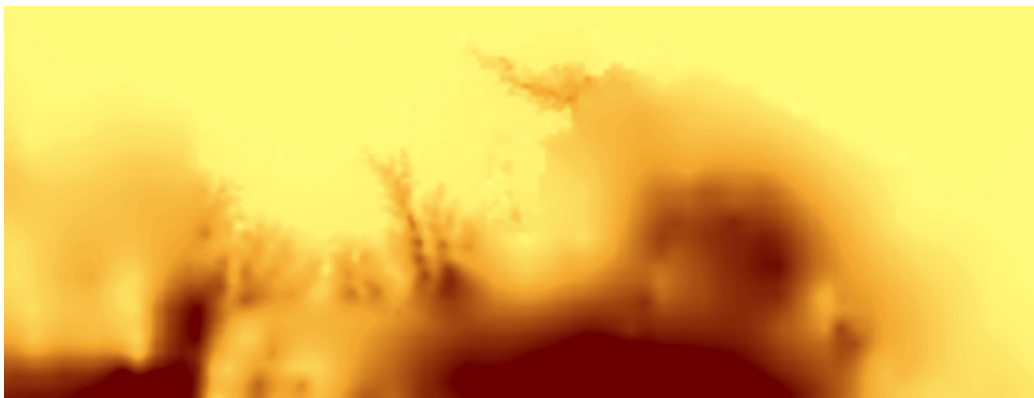
Figura 5.22 Interpolación con Spline método tensionado. Las superficies son suavizadas
