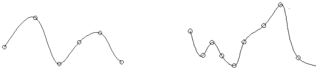
Figura 3.10. Interpolación con Spline.
