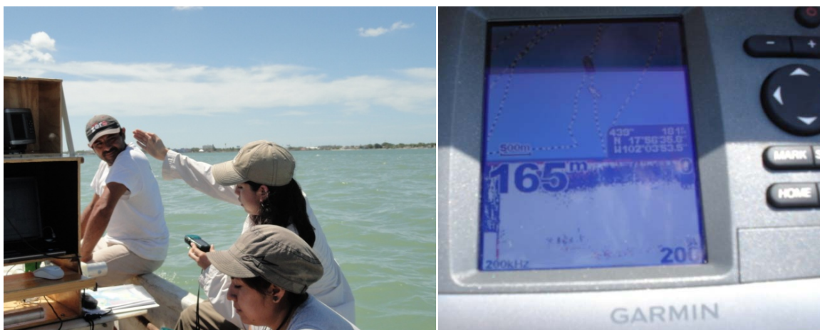
Figura 4.7. Brigada encargada del levantamiento batimétrico (izquierda) y fotografía (lado derecho) de la pantalla del GPS donde va guardando y graficando la ruta de sondeo.
