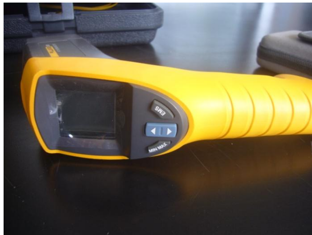
Figura 2.15 Termómetro Fluke 567 usado para medir la temperatura ambiente del lugar.
