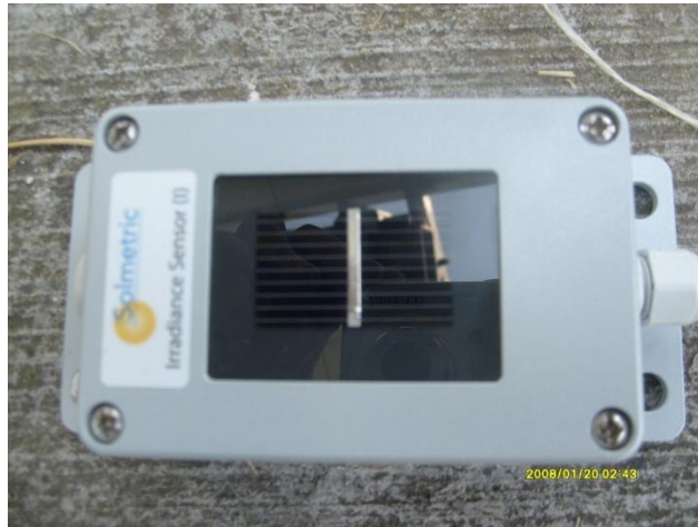
Figura 2.19 Sensor de irradiancia que nos ayuda a registrar la radiación incidente para enviar el parámetro a la computadora.
