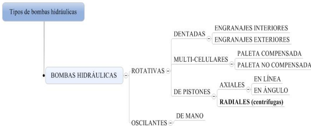
Fig. 2.1 Clasificación tipos de bombas hidráulicas.
