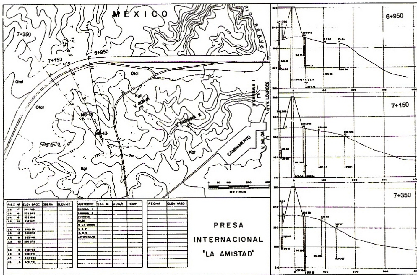
Figura 80. Presa "La Amistad", plano general de localización de perfiles de estaciones piezométricas (Hungsberg, 2001).
