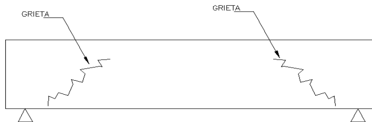
Fig. Grietas inclinadas originadas por la fuerza cortante.
