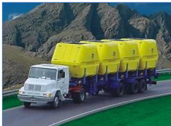
Figura 2.24 Tráiler para transportar bancos de gas natural (Ferré y Fuchs, 2009)
