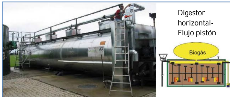
Figura 2.3 Digester horizontal (Ostrem, 2004)
