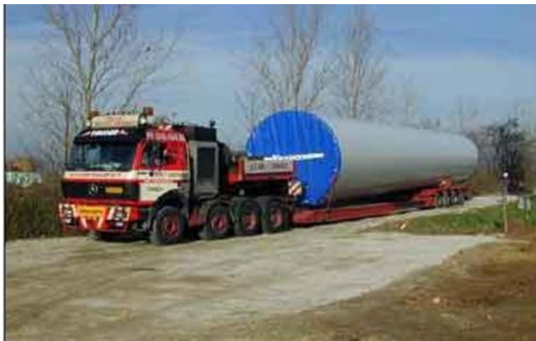
Ilustración 50. Los accesos cobran especial relevancia por la envergadura de las piezas que se deben transportar. Fuente: www.nordex-online.com
