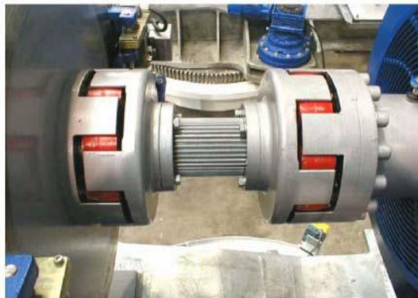
Ilustración 20. Acoplamiento flexible a la salida de la caja multiplicadora. © 1998 www.windpower.org
