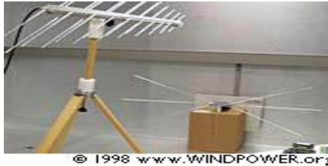
Ilustración 37. Equipo de medición de emisiones electromagnéticas
