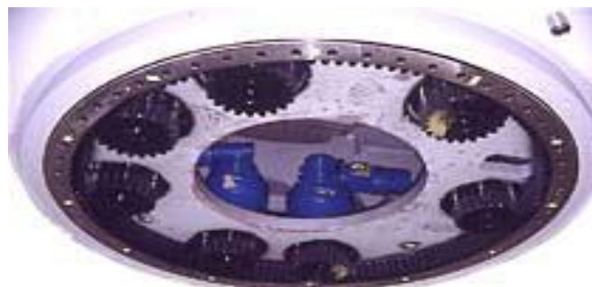
Ilustración 31. Mecanismo de orientación de una máquina típica de 750 kW.
