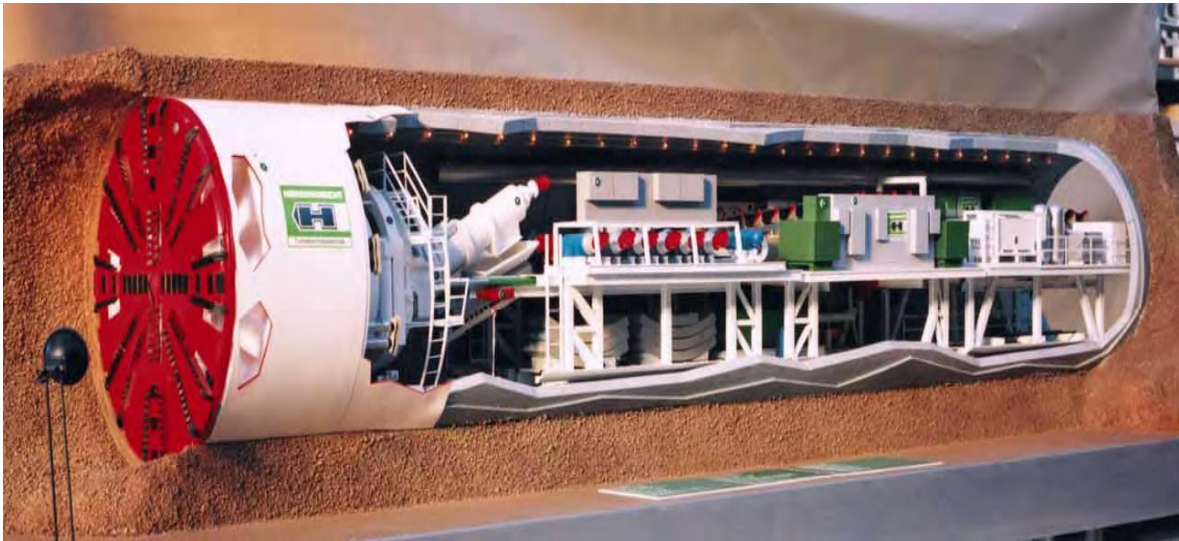
Figura (30) Vista de un escudo cerrado
