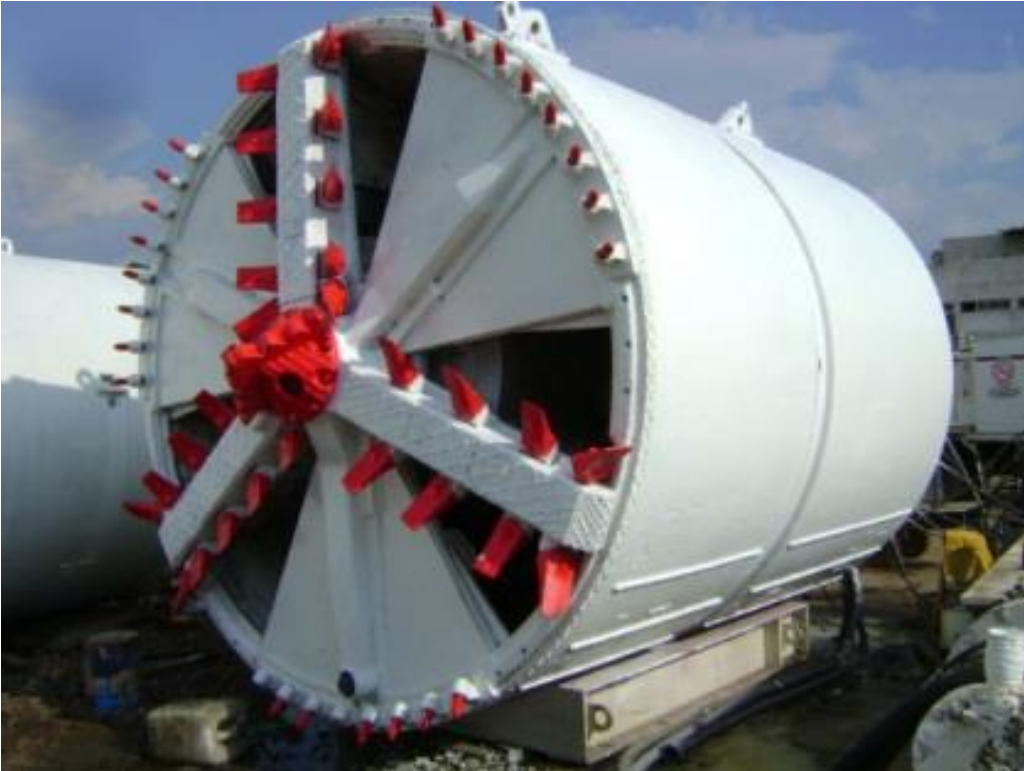
Figura (29) Vista de un escudo tipo abierto con método de excavación mecanizado (rueda)
