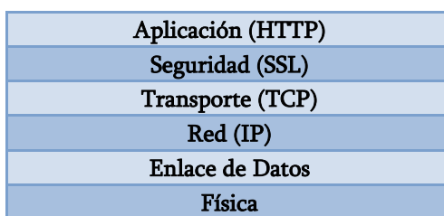
Figura 2.8.1. Uso de la capa de seguridad SSL para los navegadores de usuarios domésticos.
