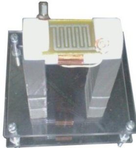
Figura IV.5. Estructura mecánica que mantiene al sensor fijo.
