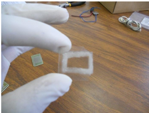
Figura IV.15. Substrato de vidrio de 100\ [\mu\text{m}] con la resina epoxi.
