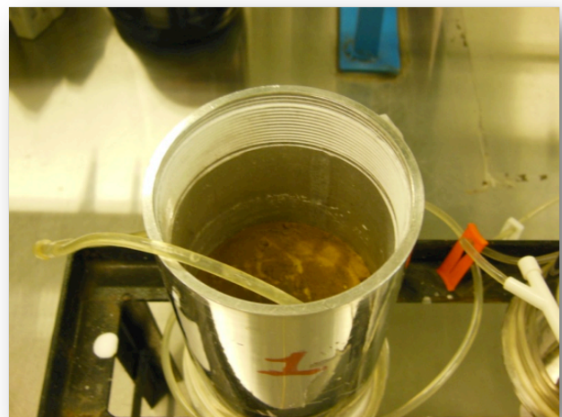
Imagen 3.4. Columna #1 con un empaque de Mn-diatomita de 5 cm.
