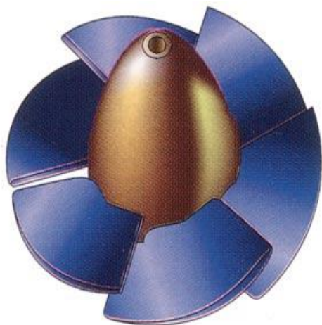
Figura 1- 15. Rotor de Turbina Kaplan.
