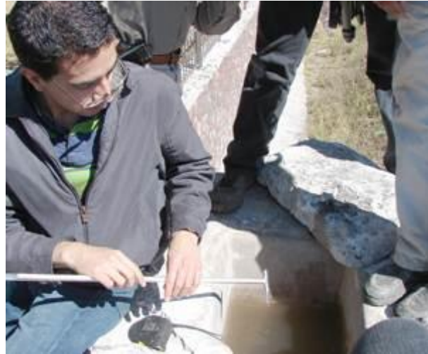
Imagen 3. 1. Medición con el tubo de Pitot (El Sol de Hidalgo, versión en línea, 2013)
