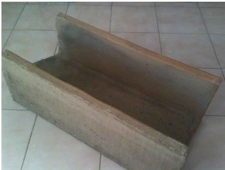
Imagen 3. 3. Tramo de canal de barro previo a la aplicación del recubrimiento
