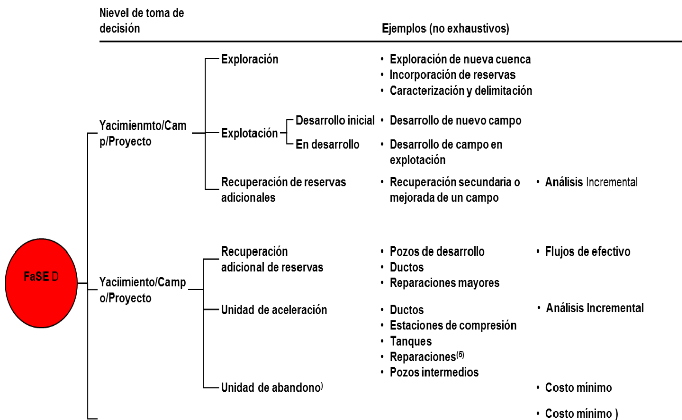
Fig. 24 clasificación de unidades de inversión para identificación de tipo de análisis requerido
