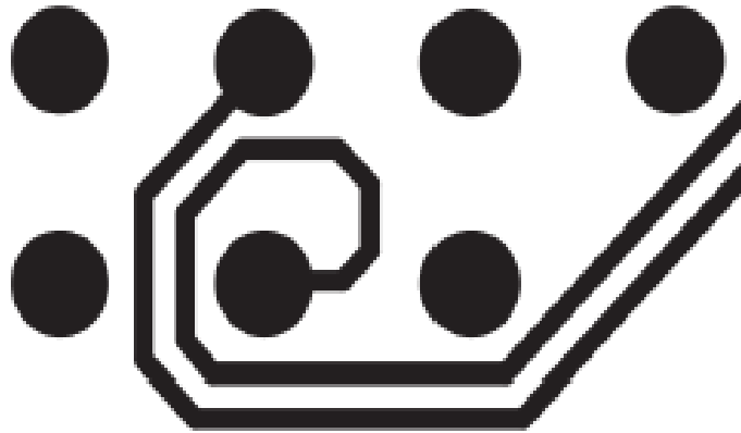
Figura 5.-Ajuste de longitud en el par diferencial.
