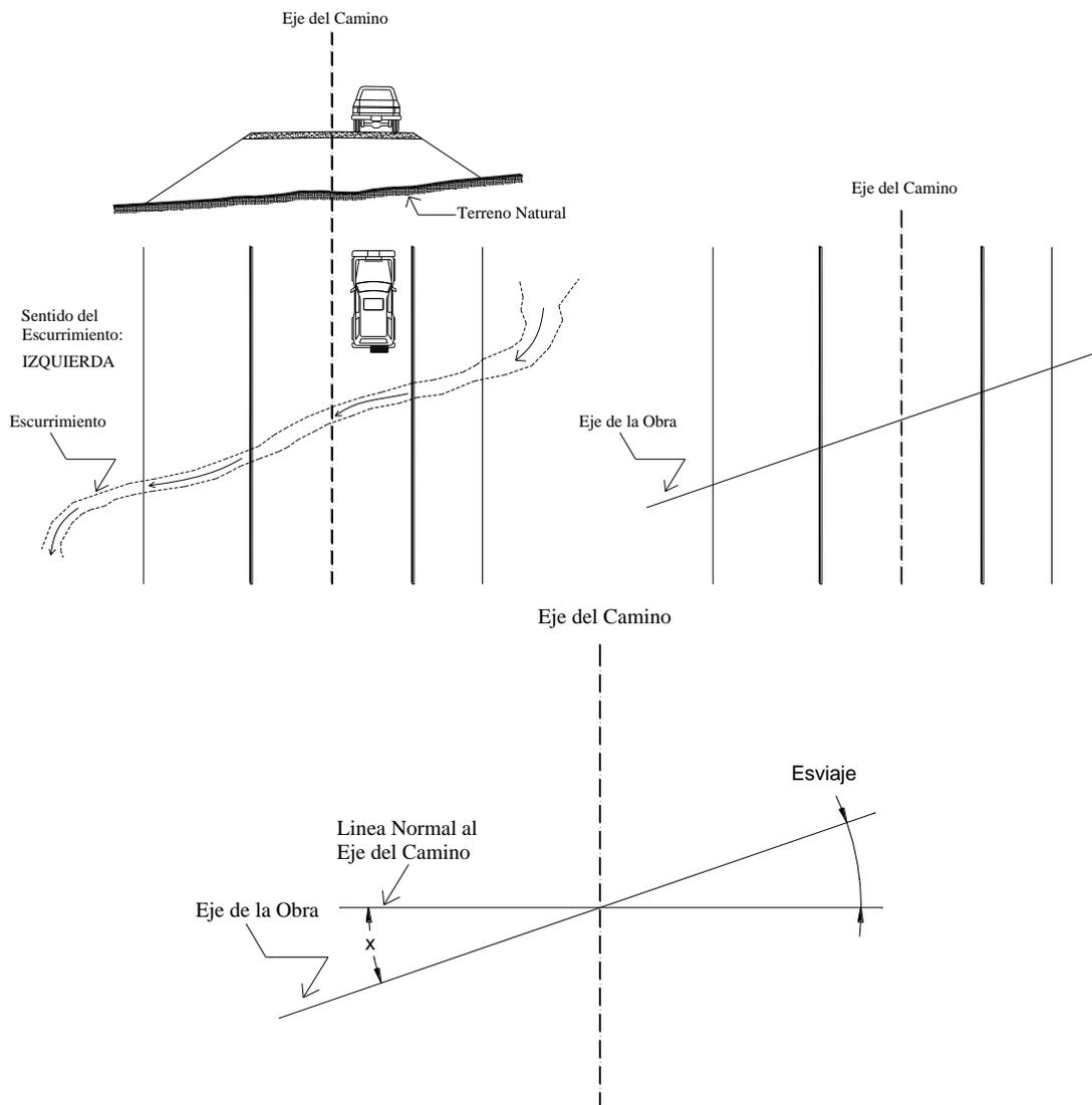
**Figura 2.2.1** Esquema del Esviaje de una alcantarilla
