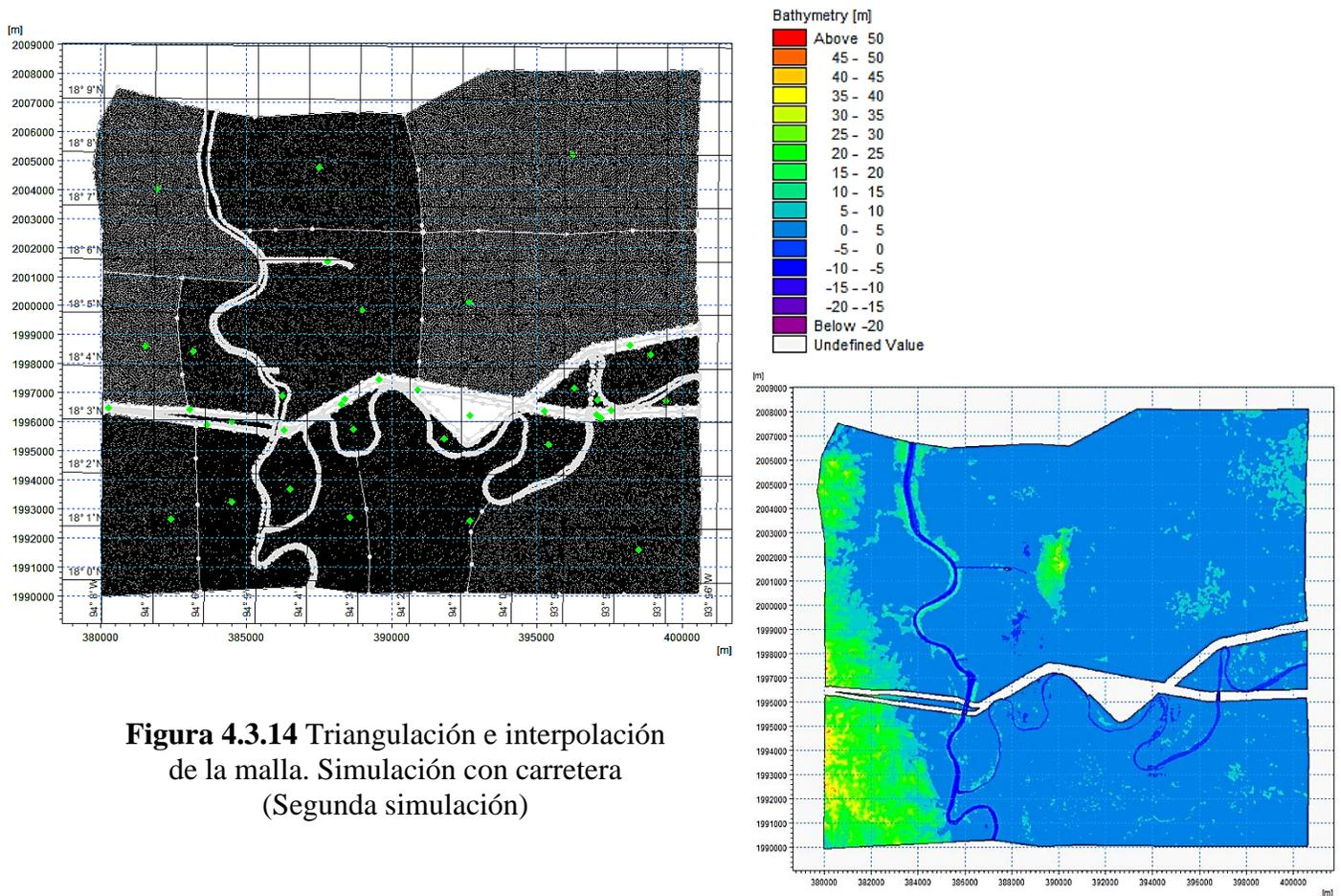
**Figura 4.3.14** Triangulación e interpolación de la malla. Simulación con carretera (Segunda simulación)
