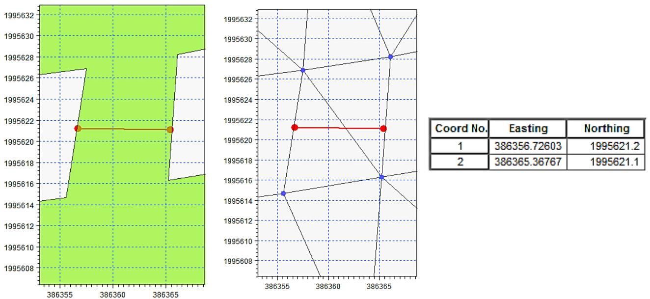
**Figura 4.3.6** Digitalización y representación de las alcantarillas en Flow Model
