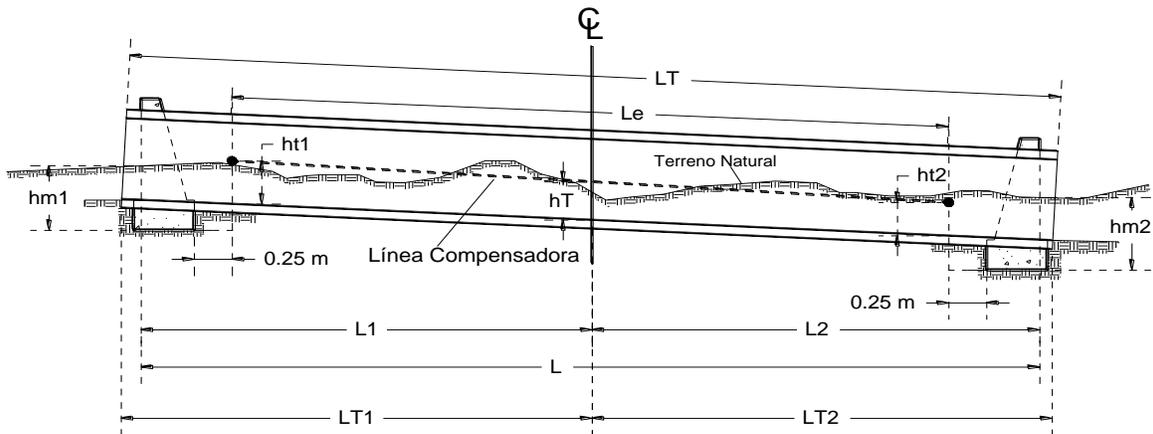
**Figura 2.2.6** Corte longitudinal de tubo de concreto para proyecto tipo.
