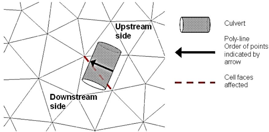
**Figura 4.3.5** Esquema de Ubicación de estructuras (Culvert Localization)
