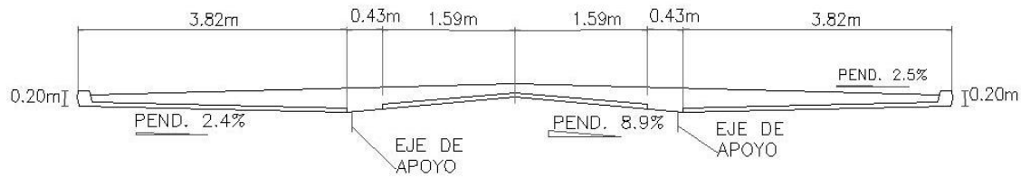
Figura 1.5 – Geometría de las tabletas
