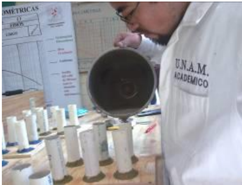
Figura 2.1.6. Llenado de probetas.
