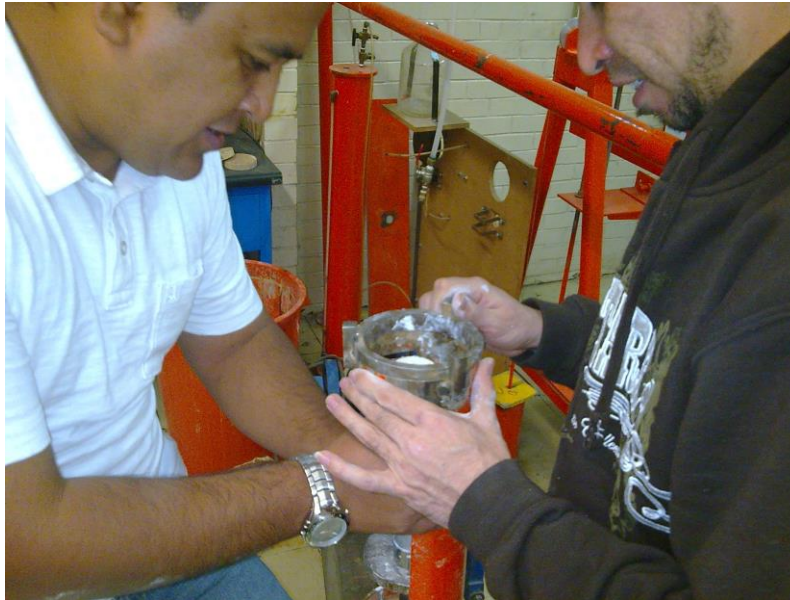
Figura 2.1.8 Extracción de la probeta del tubo PVC.
