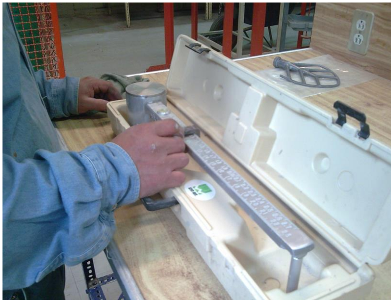
Figura 2.1.5. Obtención de densidad del lodo fraguante con la balanza.
