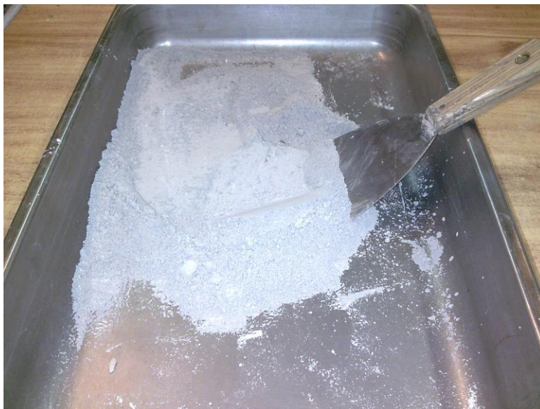
Figura 2.1.1. Mezclado de Bentonita cemento sin hidratación.
