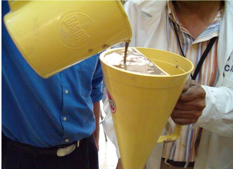
Figura 1.5.1. Medición de la viscosidad con el cono March.
