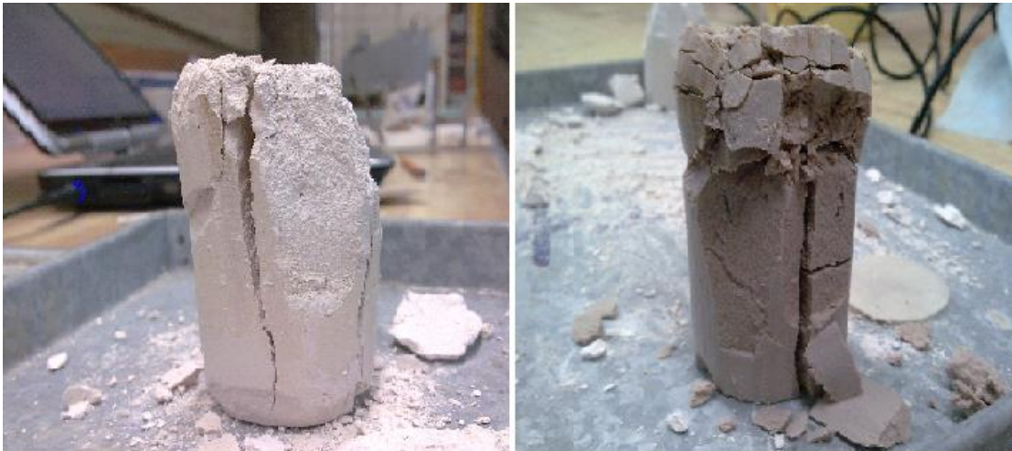
Figura 2.2.5. Tipo de fallas en probetas fraguadas en condiciones saturadas.
