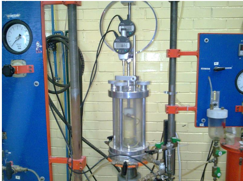
Figura 2.2.2. Ensayo de compresión simple.
