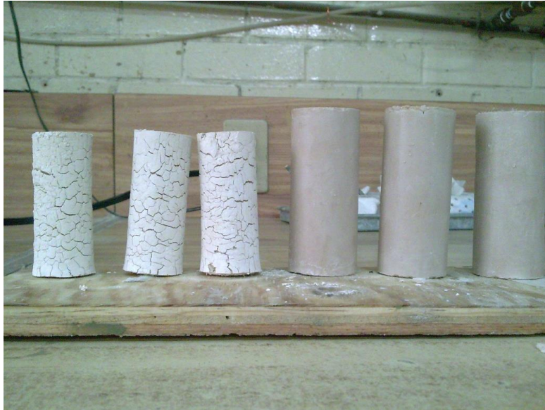
Fig. 3.1 Apariencia y contracción volumétrica de especímenes.
