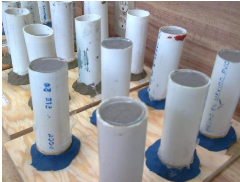
Figura 2.1.7. Probetas en proceso de fraguado.
