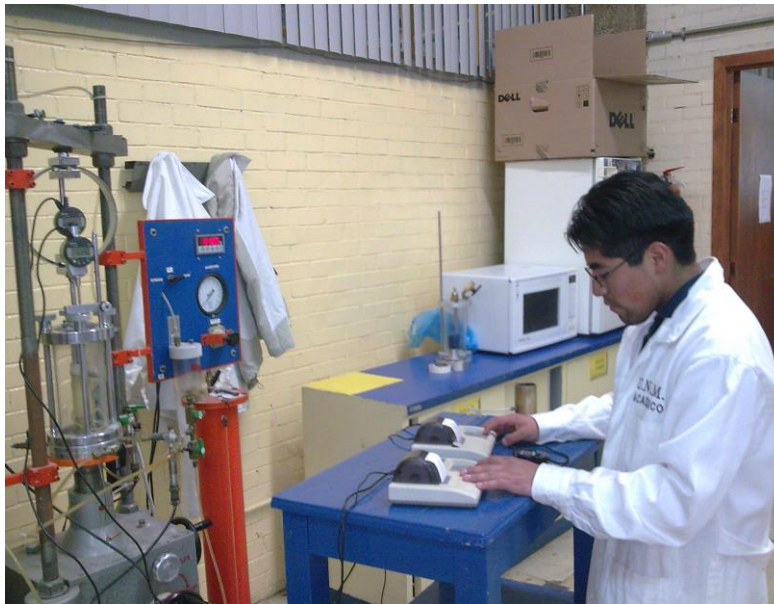
Figura 2.2.3. Prueba de compresión simple, registro de lecturas.
