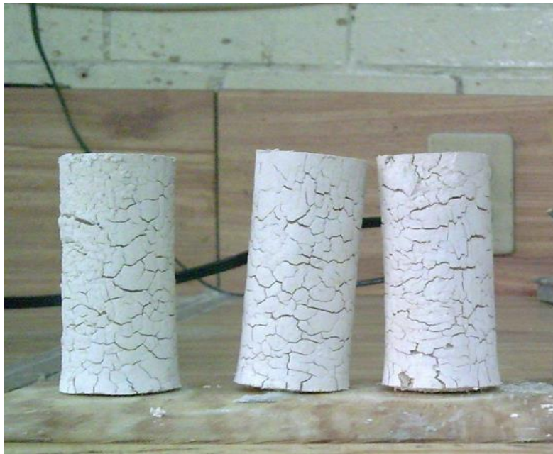
Figura 2.2.4. Probets fraguadas a la intemperie.
