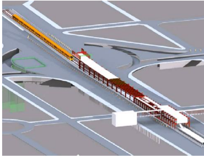
Fig. 58 Montaje de columnas secundarias y travesas transversales a nivel de losa de azotea.
