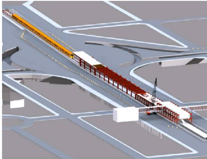
Fig. 57 Colocación de sistema de entripiso.
