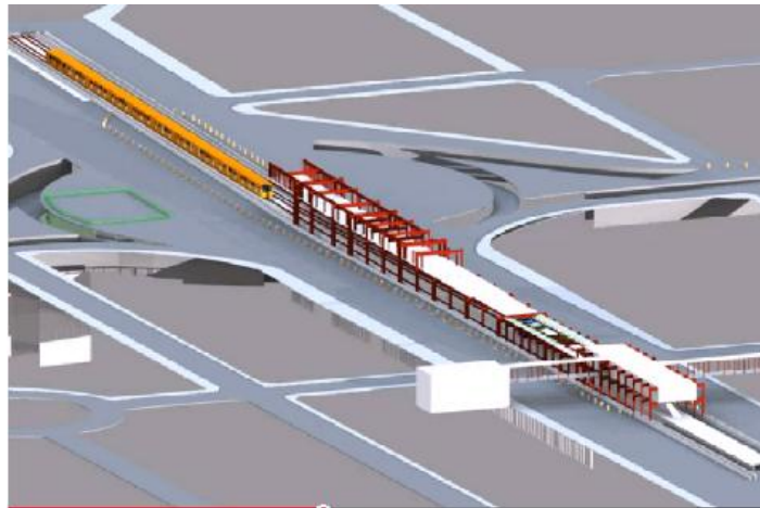
Fig. 59 Montaje de travesas longitudinales a nivel azotea.
