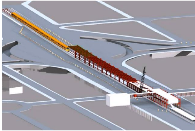
Fig. 56 Montaje de traveses principales.
