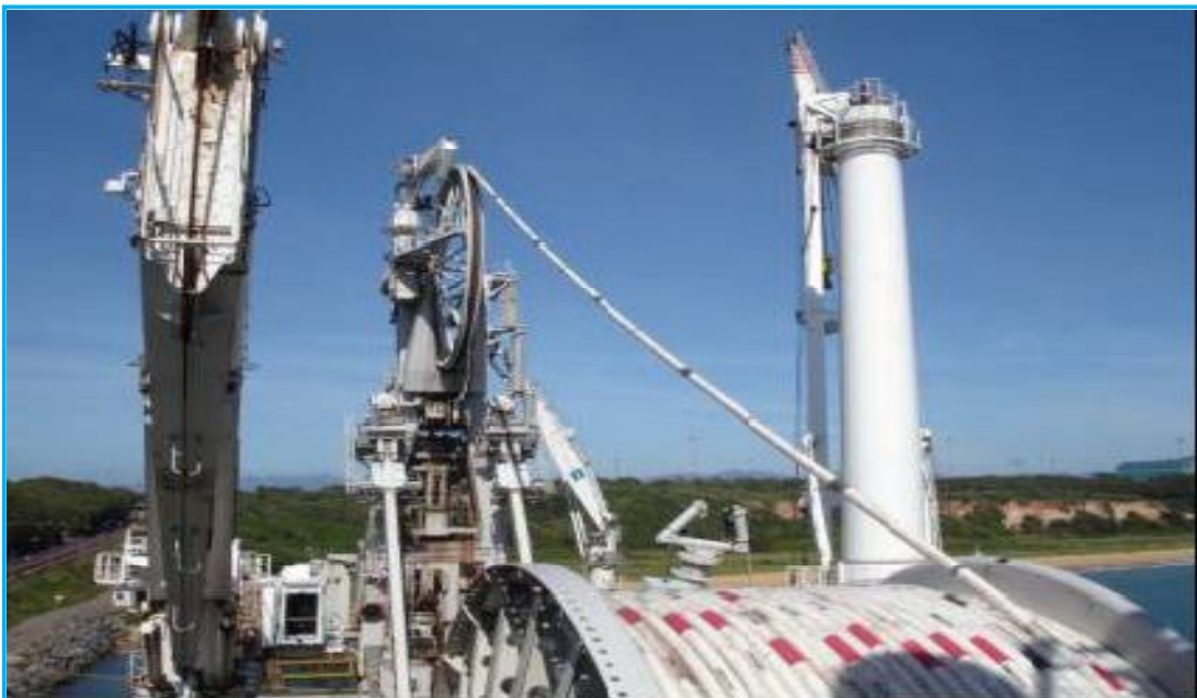
Figura 5-7) Enrolladores de tuberías.
