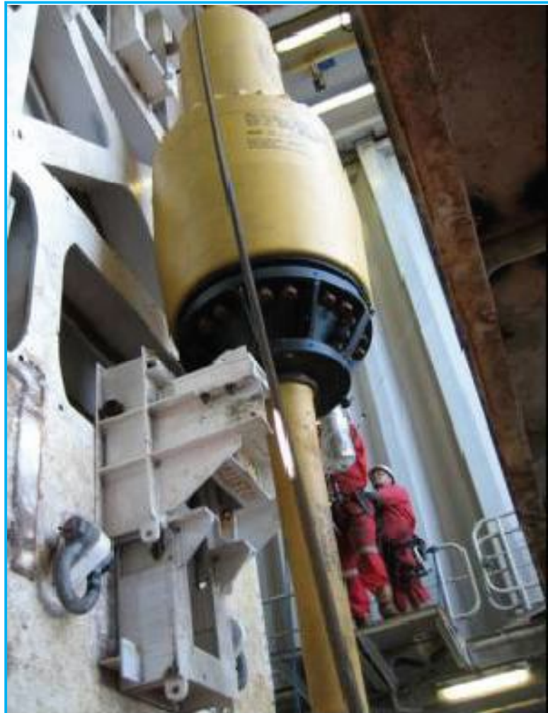
Figura 5-9) Junta flexible diseñada por Shell.
