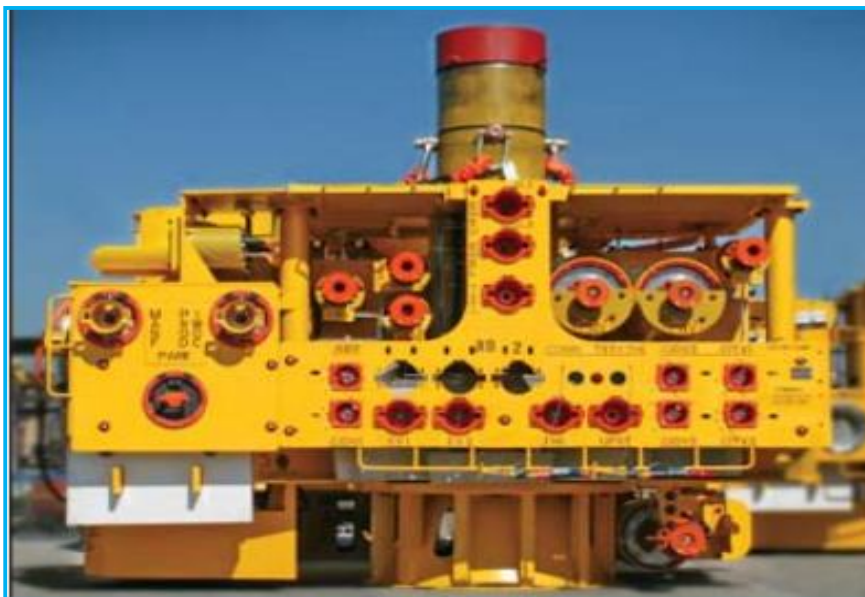
Figura 2-10) Árbol de producción horizontal de la compañía FMC Technologies Inc.
