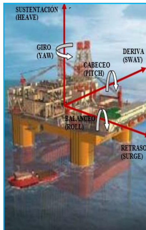
Figura 4-3) Grados de libertad en una unidad de producción superficial.
