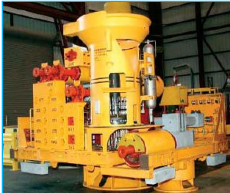
Figura 2-11) Árbol de producción vertical de la compañía FMC Technologies Inc.
