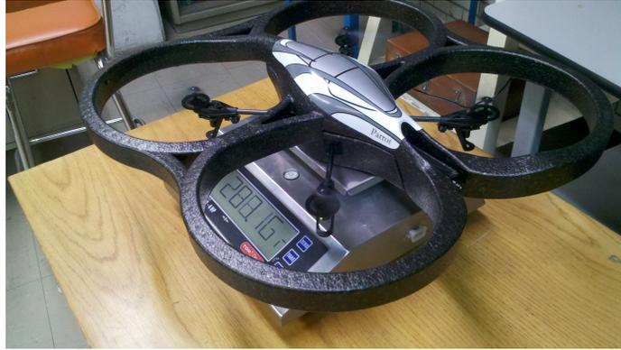
Figura 2.3 Medición del coeficiente de empuje.
