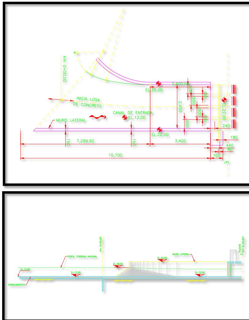
Ilustración 2.27. Canal de Entrada en formato CAD, planta y perfil.
