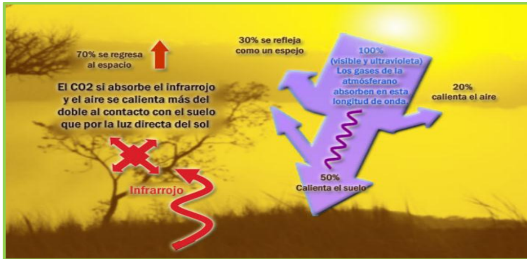
Figura 1-1 Efecto invernadero: nótese el cambio de longitud de onda entre la luz que incide en la superficie terrestre y la que es reflejada por la superficie terrestre una vez que se ha calentado. Fuente: Revista digital universitaria, 2008.
