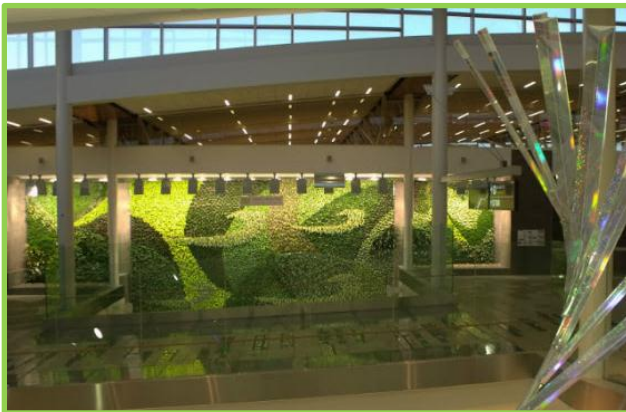
Figura 6-5 Muro verde en el aeropuerto de Edmonton, formado por 8.000 plantas de 32 especies diferentes, construido con materiales reciclados y cultivo hidropónico. Fuente: http://www.medioambiente.org
