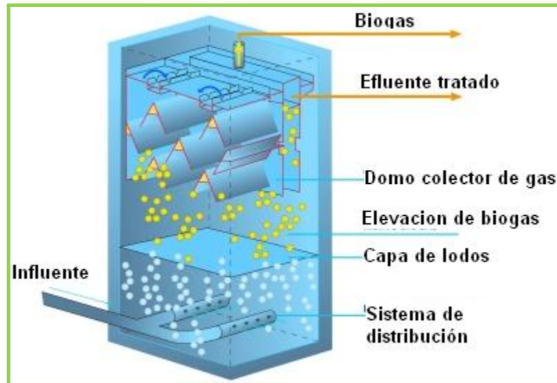
Figura 4-5 Componentes de un Reactor UASB. Fuente: http://intalaspengolahanairlimbah.blogspot.mx/
