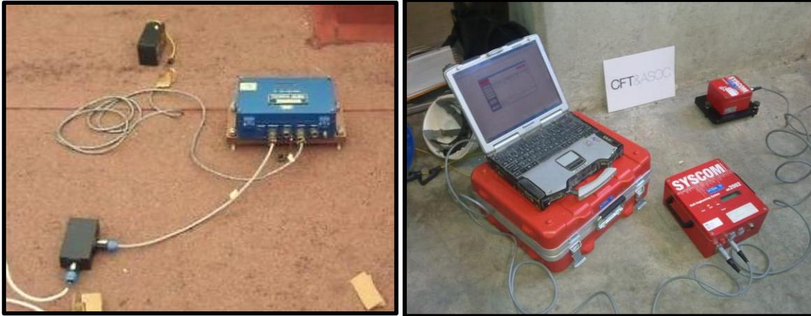
Figura 4.27.- Equipos de medición de vibraciones (acelerómetros).
