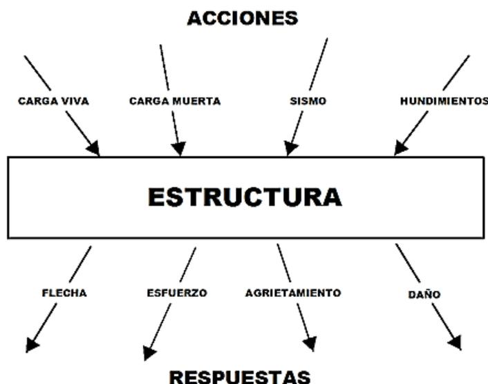
Figura 2.1.- Representación esquemática de acciones actuando sobre una estructura.<sup>1</sup>
