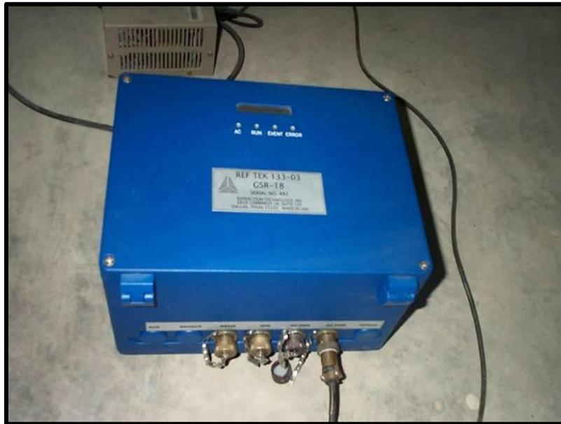
**Figura 5.4.-** Acelerógrafo usado en mediciones dinámicas marca Terra Technology.
